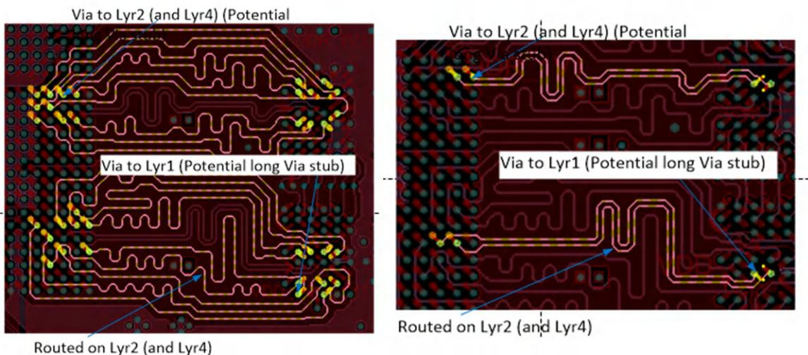
**Figure 3-8. Example LPDDR4 Data Byte(s) and DQS(s) Routing**
